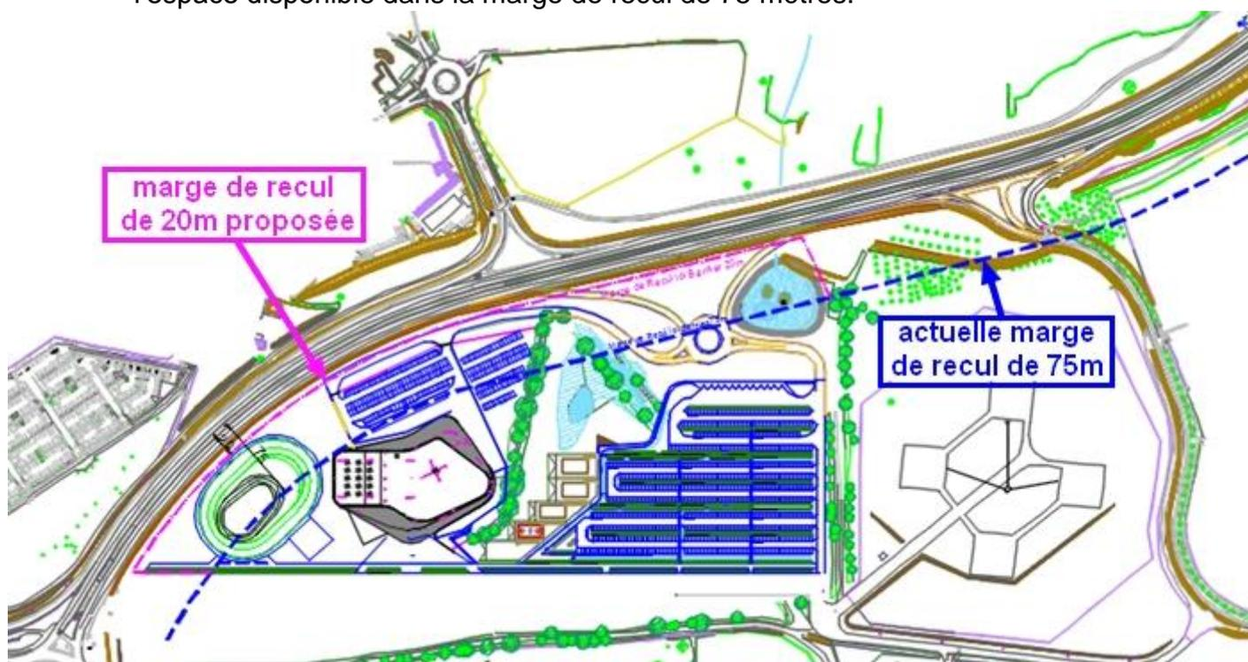
Figure 11 : implantation du plan de masse & marge de recul
