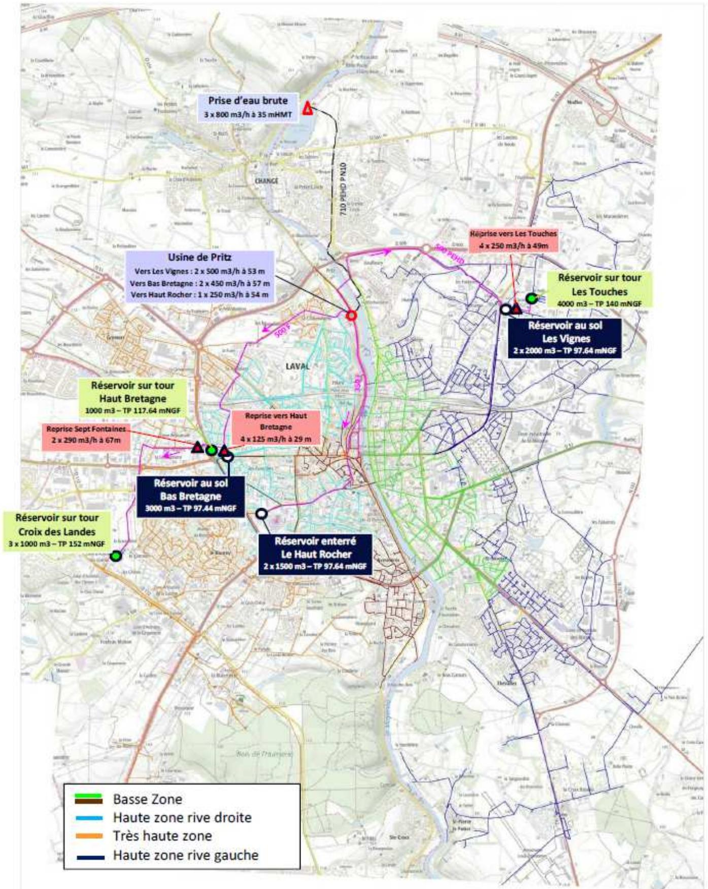
**Localisation du site de la nouvelle usine à Changé et des conduites de transfert d'eau traitée vers les réservoirs du réseau de distribution d'eau potable de Laval Agglo**
