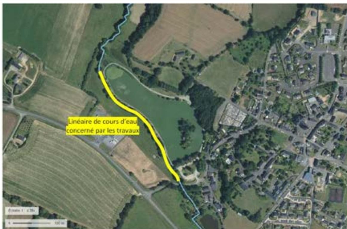
Travaux réalisés par l'entreprise SNTP Salmon (Soulgé-sur-Ouette – 53) : recharge granulométrique sur environ 300 ml (cailloux concassé  $\varnothing$  10-40 mm > 50 T, cailloux concassé  $\varnothing$  25-60 mm > 130 T, cailloux concassé  $\varnothing$  30-120 mm > 80 T).
