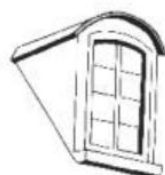
Lucarne à arc surbaissé
