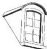
Lucarne à arc surbaissé
