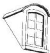
Lucarne à arc surbaissé
