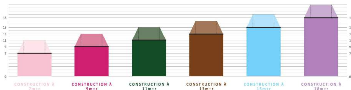
Schéma de principe des 6 catégories des hauteurs de constructibilité maximale autorisées r = retrait de 2 m par rapport à l'alignement, pour une constructibilité maximale de 4 m
