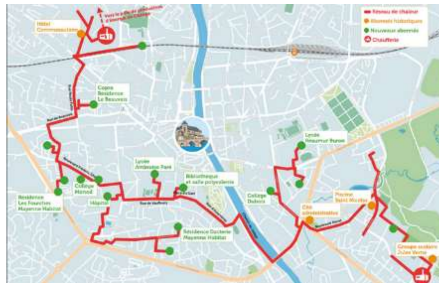
5 km de réseau et de 6 km de ramifications (source: site LEN - 2017)
